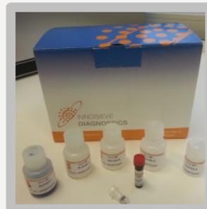
Mit dem **Sieve-ID® Sporennachweisset** werden die *Botrytis cinerea* Sporen auf einfache Weise innerhalb von 15 Minuten fluoreszierend gefärbt.
