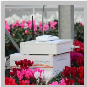
Innerhalb weniger Minuten wird eine repräsentative Menge an Luft über eine innovative Mikromembran gefiltert. Die eventuell in der Luft vorhandenen *Botrytis cinerea* Sporen werden hiermit aufgefangen.
