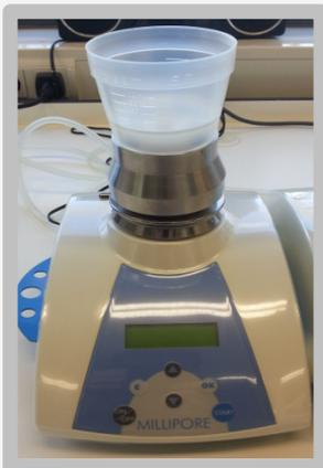
Mit Hilfe eines Filtergerätes wird innerhalb weniger Minuten eine repräsentative Menge Nährlösung über eine innovative Mikromembran gefiltert. Die eventuell im Wasser vorhandenen Mikroorganismen verbleiben auf dieser.
