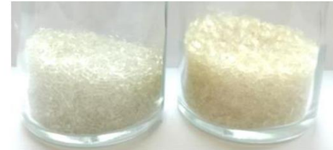
Abbildung 15: (Links) PLA Rezyklat aus dem Industrieabfall (Stanzgitter, Input Bösel Management GmbH), (Rechts) PLA Rezyklat des post-consumer PLA Abfall S.
