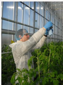
Im Gewächshaus werden kleine, drahtlose Sensoren für Temperatur und Luftfeuchtigkeit aufgehängt - mindestens 10 pro ha. Ein dichtes Messnetz gibt eine bessere Übersicht über die extremen Stellen und das dynamische Verhalten des Klimas.
